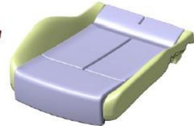
Abbildung 72: Lösungsweg zu den Sitzkonstruktionsrichtlinien für einen ergonomischeren Einstieg in den Audi TT.
